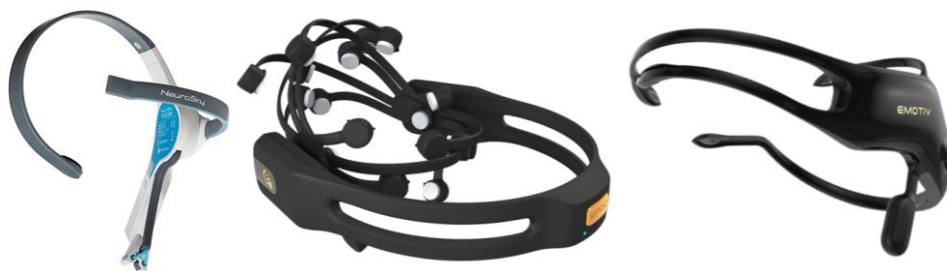
Рисунок 1 – Энцефалографы, слева направо: NeuroSky MindWave, Emotiv EPOC/EPOC+, Emotiv Insight
