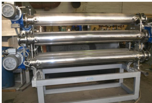
Рисунок5 – Кристаллизатор-охладитель жира перед фасовкой (вотатор)
