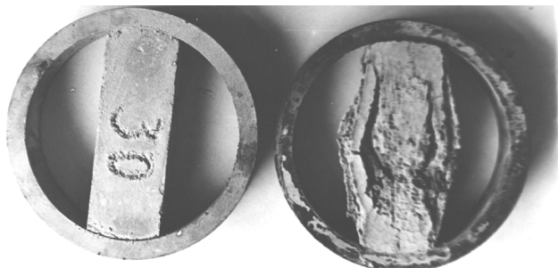
Рис. 1. Разрушение структуры напрягающего бетона при использовании активных составов в условиях ограничения деформаций расширения по направлению одной оси
