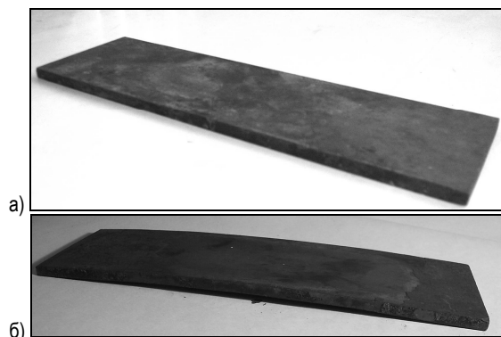
а – образец из стали 6ХВ2С до ТО, б – образец из стали 6ХВ2С после ТО
