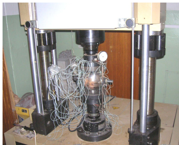
Рис. 2. Общий вид испытаний узловых элементов в условиях осесимметричного нагружения: а) растяжения, б) сжатия
