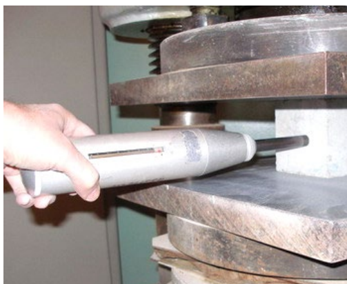
Рис. 5. Испытания бетонных образцов-кубов для построения градуировочных зависимостей а – ультразвуковые измерения образца; б – испытания молотком Шмидта
