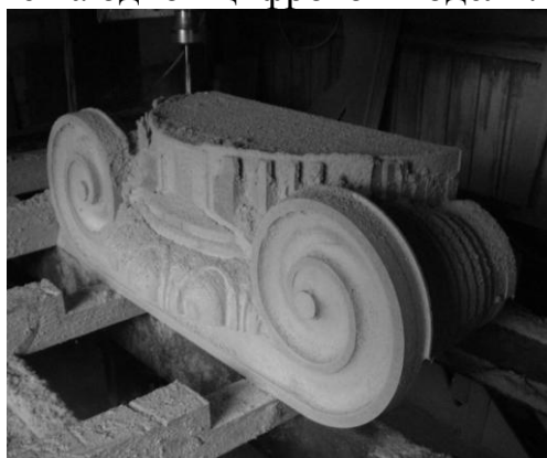
Рисунок 4 – Изготовление модели капители на фрезерном ЧПУ станке
