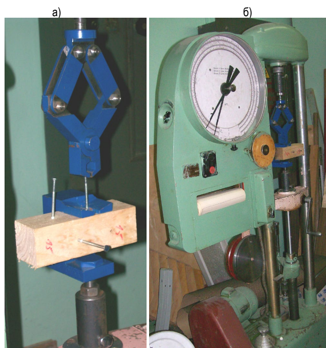
Рис. 3. Испытание гвоздей на выдергивание
