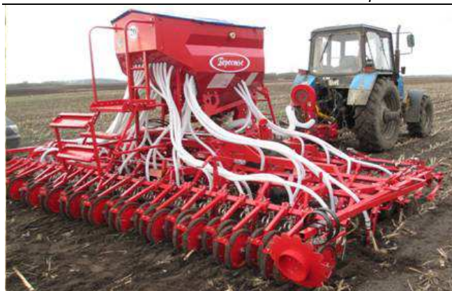
Рисунок 1 – Сеялка пневматическая СПЛ-6 с трактором «БЕЛАРУС 1221» при выполнении технологического процесса посева зерновых культур
