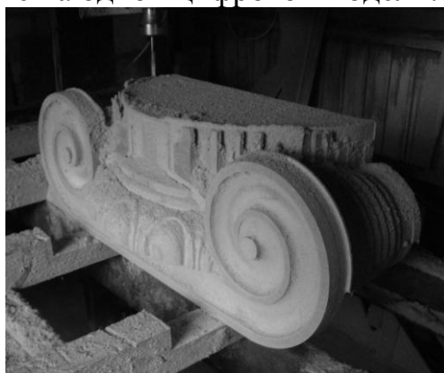
Рисунок 4 – Изготовление модели капители на фрезерном ЧПУ станке
