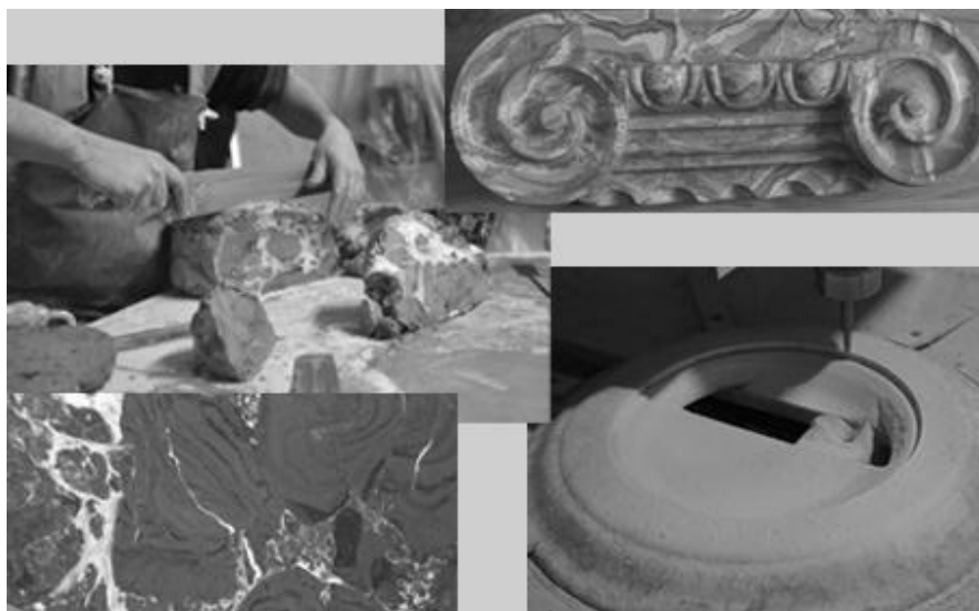
Рисунок 7 – Этапы изготовления изделий по технологии скальола
