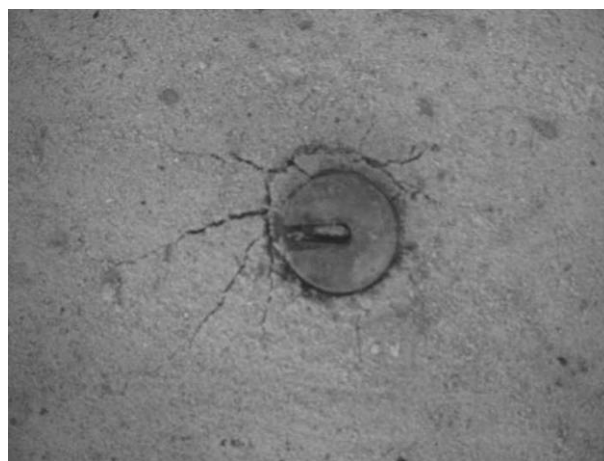
Рис. 4. Образование трещин на поверхности грунта на стадии расширения
