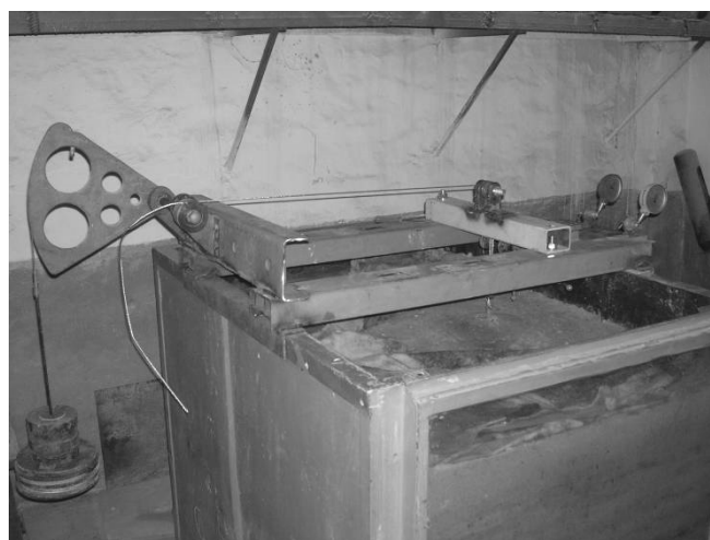
Рис. 6. Испытание моделей буронабивных свай
