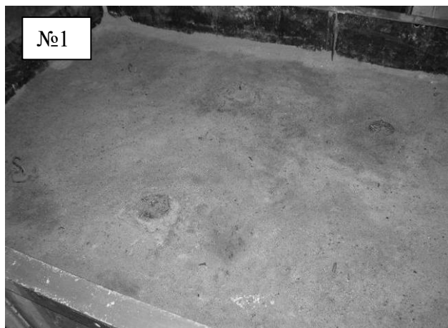
Рис. 5. Общий вид лотков с забетонированными моделями до и после испытаний
