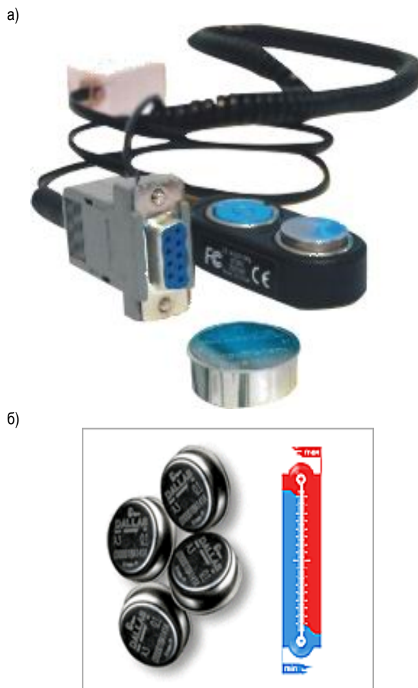
Рис. 1. Контрольно-измерительная аппаратура системы температурного мониторинга «Термохрон»: а – адаптер АС-Термохрон с установленным измерителем - регистратором температуры; б – измерители-регистраторы температуры
