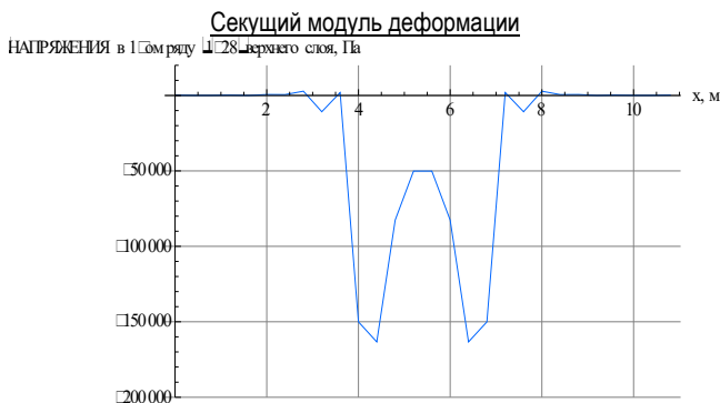
Рис. 9. Эпюры напряжений \sigma_y^k под плитой (горизонтальный срез) на глубине: — h = \Delta y / 2 ; — h = 3\Delta y / 2 ; — h = 5\Delta y / 2
