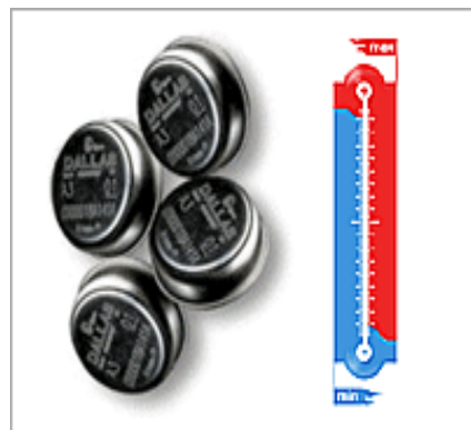
Рис. 1. Контрольно-измерительная аппаратура системы температурного мониторинга «Термохрон»: а – адаптер АС-Термохрон с установленным измерителем - регистратором температуры; б – измерители-регистраторы температуры
