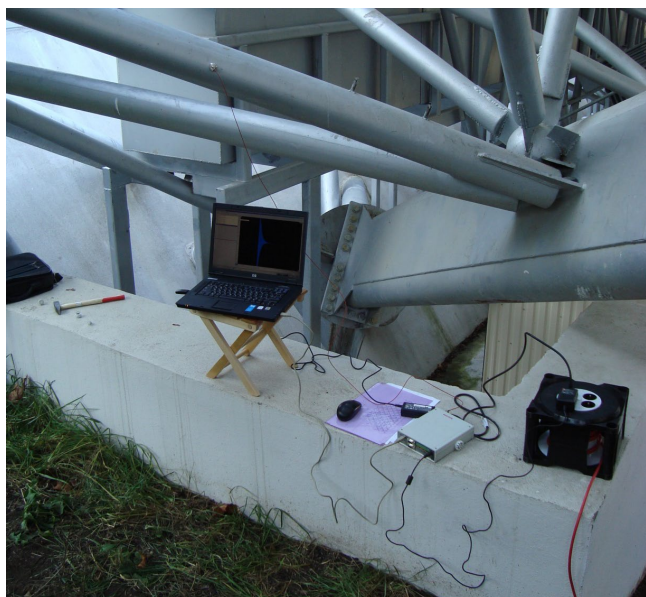
Рис. 2. Измерение собственной частоты колебания стержня структурной оболочки Летнего амфитеатра в г. Витебске
