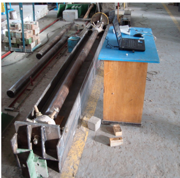
Рис. 5. Испытательный стенд для торировки стержней структурной конструкции
