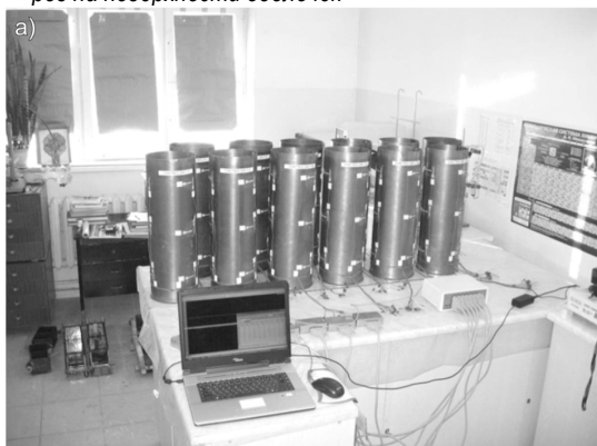
Рис. 5. Стальные оболочки для изготовления самоупроченных сталебетонных элементов: а) геометрические параметры оболочек; б) схема расположения тензорезисторов на поверхности оболочек
