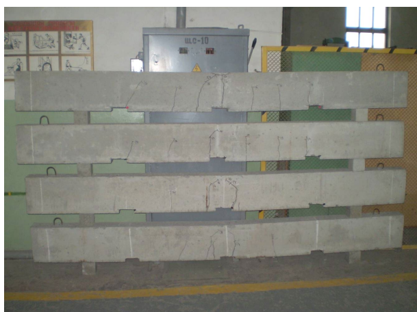
Рис. 2.4. Характерная картина трещинообразования балок при испытаниях
