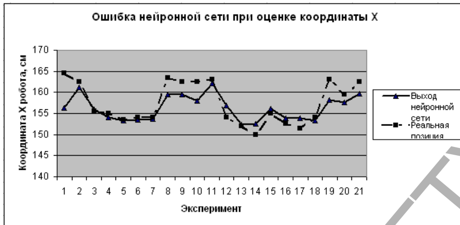
Рисунок 6 – Аппроксимация ошибки одометров нейронной сетью
