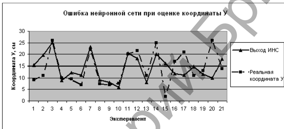
Рисунок 7 – Аппроксимация ошибки одометров нейронной сетью
