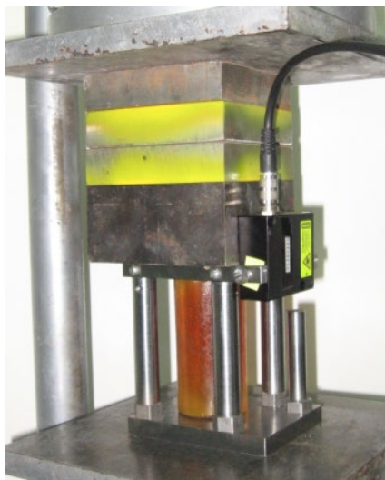
Рис. 4. Общий вид устройства для определения модуля упругости
