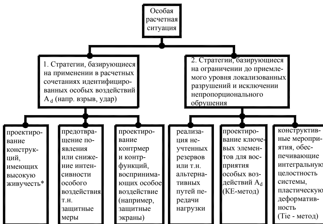
Рис. 1. Расчетные стратегии, применяемые при проектировании конструктивных систем в особых расчетных ситуациях
