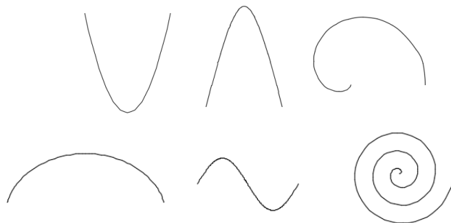
Рисунок 1 – Параметрические модели закономерных линий (парабола, гипербола, эвольвента окружности, циклоида, синусоида, спираль Архимеда)
