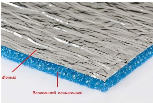
Рисунок 2. Материал «Пенофол» для изготовления гибких воздуховодов.
