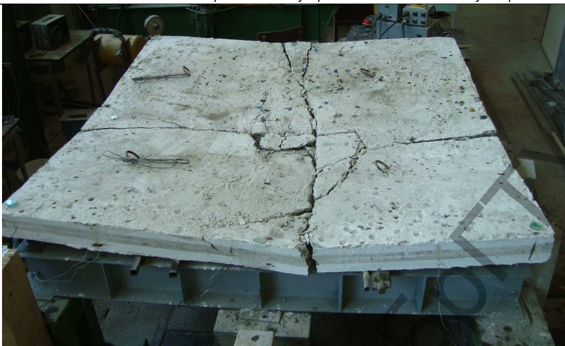
Рис. 4. Общий вид плиты ПГ-2.1 после разрушения
