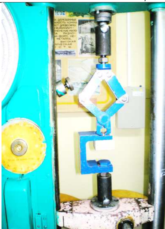
Рис. 2. Приспособление для выдёргивания шурупов
