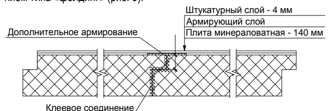
Рис. 3. Конструктивное решение стыка типа «фолдинг»
