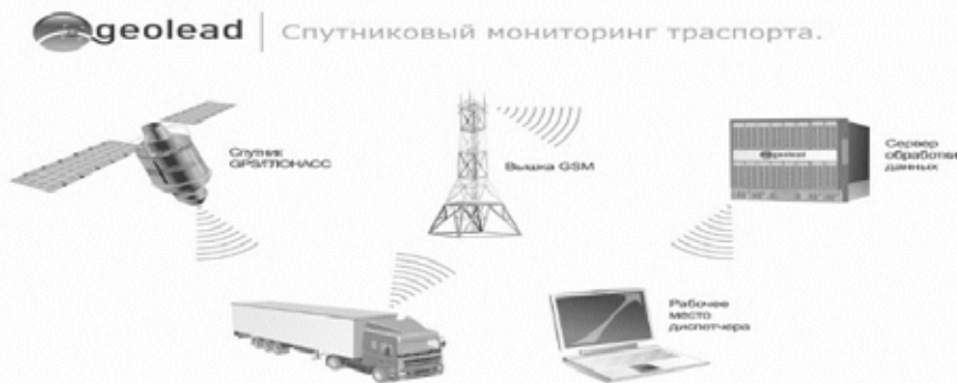
Рисунок 1. Схема взаимодействия систем спутникового мониторинга
