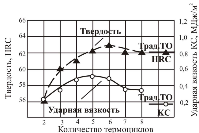
Рис. 3. Влияние количества циклов при УТЦО на свойства стали У8. Закалка с термоциклом 790 °С ↔ 250 °С и выдержкой 10 мин., отпуск при 180 °С, 1,5 ч. Образцы: 10×10×55 мм.
