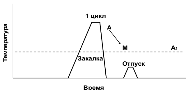
Рис. 1. Диаграмма традиционной термической обработки стали У8
