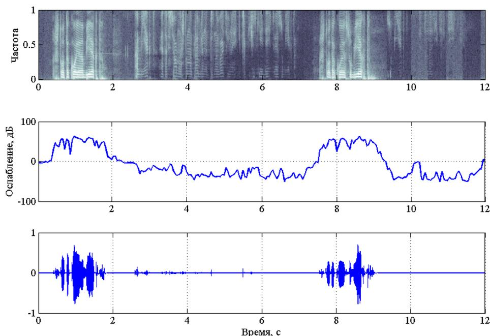
Рис. 12. Спектрограмма обработанного сигнала, график оценки ERLE и результат
