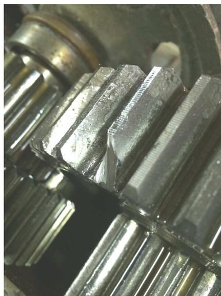
Рисунок 2 – Общий вид исследуемой шестерни с локальным дефектом в виде скола зуба
