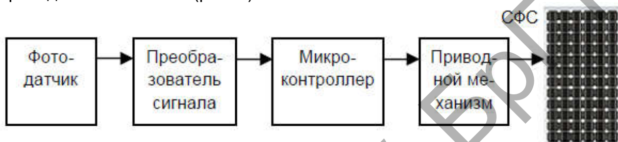
Рисунок 4 - Структурная схема системы отслеживания за Солнцем
