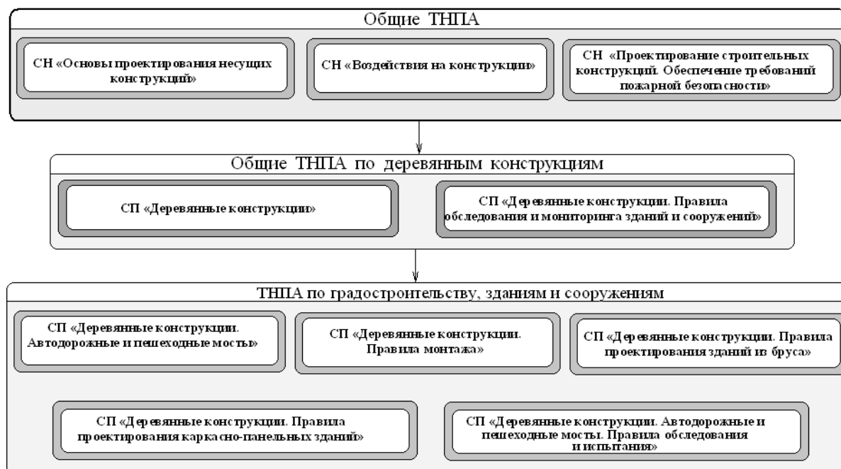
Рисунок 2 – Общая схема предлагаемой структуры строительных норм и строительных правил, относящихся к области проектирования, монтажа и оценки технического состояния деревянных конструкций
