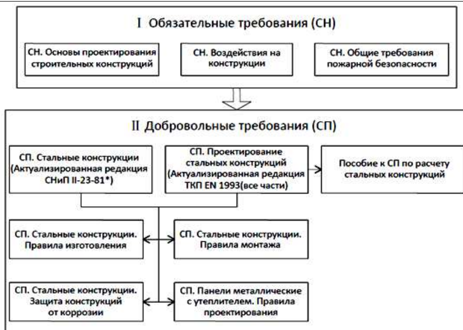
Рисунок 2 – Предлагаемая структура СП и СН в области стальных конструкций
