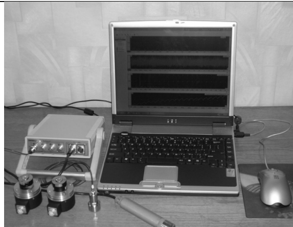
Рисунок 2 – Общий вид измерительной системы анализа вибрационных характеристик ВИКМА-1
