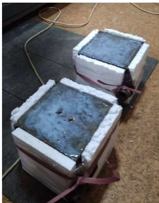
Рисунок 2 – Опытные образцы в изолированной форме с покрытием неизолированной поверхности полиакриловой дисперсией
