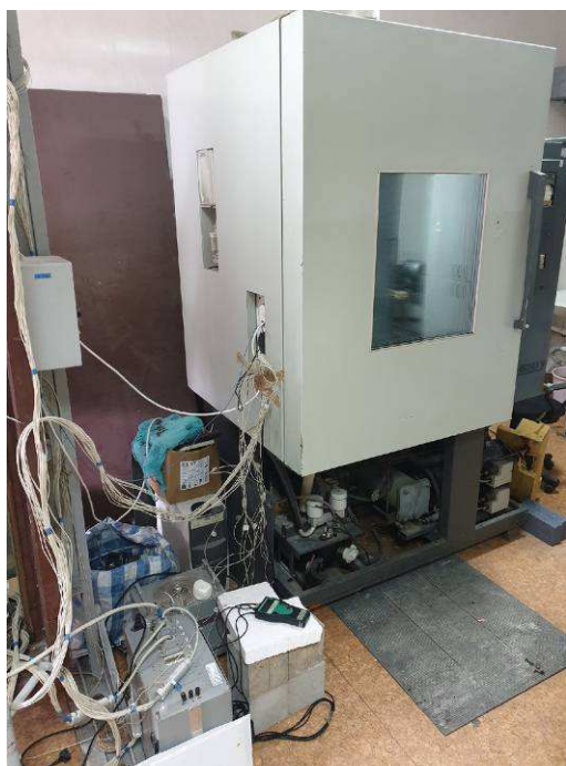
Рисунок 1 – Камера для инфракрасного прогрева
