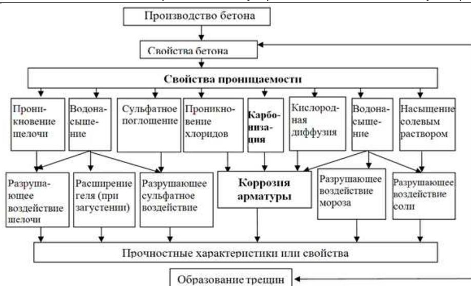
Рисунок 1 – Дegradaция железобетонных конструкций [2]
