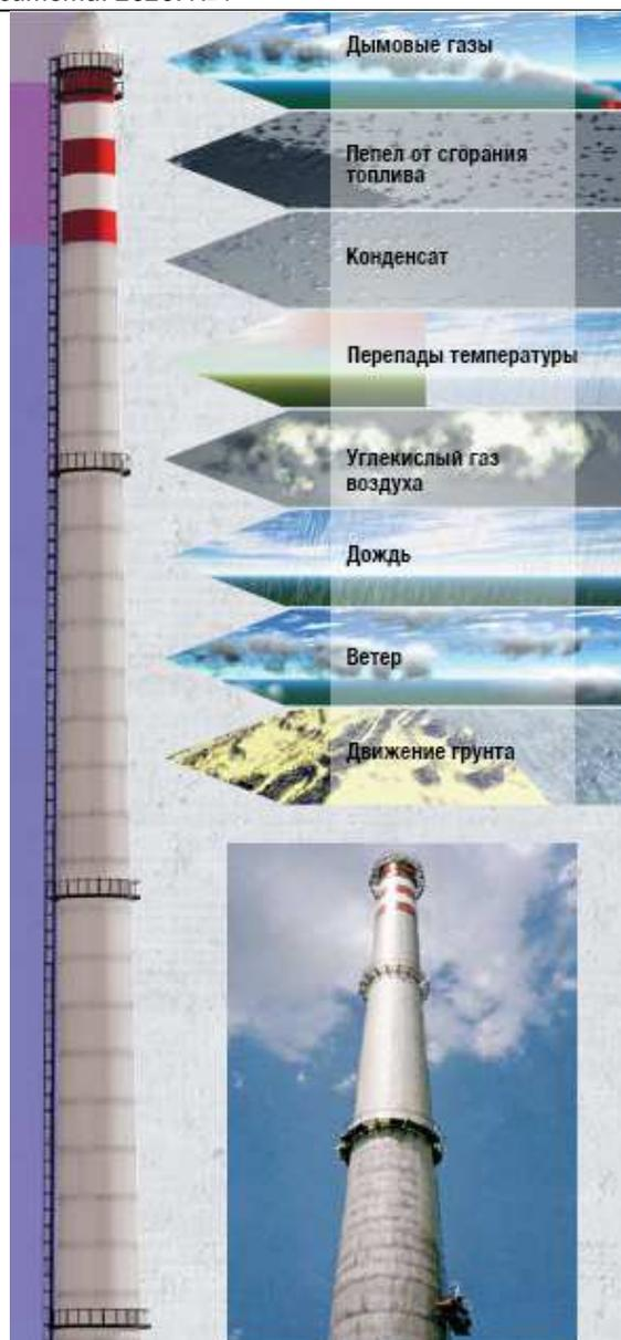
Рисунок 2 – Условные «агрессивные» зоны по высоте дымовой трубы [3]
