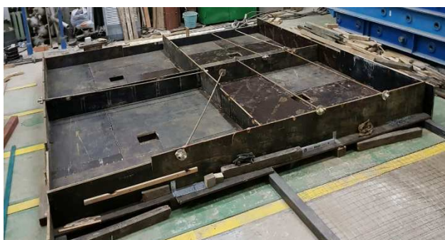
Рисунок 2 – Опалубка для изготовления образцов
