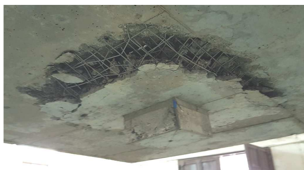
Рисунок 11 – Характерная форма разрушения при местном срезе, полученная при испытаниях плиты ПБ II-3-3
