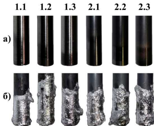
Рисунок 1 – Экспериментальные образцы с покрытием до погружения в расплав (а) и извлеченные из контейнера (б): 1.1, 1.2, 1.3 – образцы с неазотированной основой; 2.1, 2.2, 2.3 – образцы с азотированной основой
