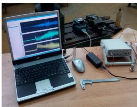
Рисунок 1 – Контрольно-диагностический комплекс, используемый в эксперименте и пьезо-электрический акселерометр модели AP-98
