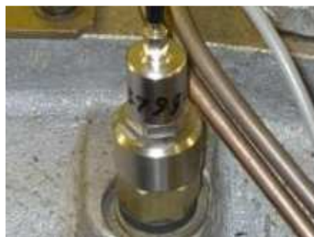
Рисунок 1 – Контрольно-диагностический комплекс, используемый в эксперименте и пьезо-электрический акселерометр модели AP-98
