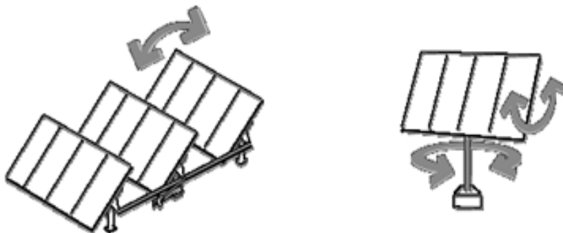
Рисунок 1 – Схематичное представление одноосевой и двухосевой системы слежения
