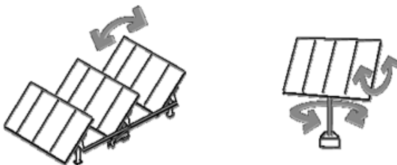
Рисунок 1 – Схематичное представление одноосевой и двухосевой системы слежения
