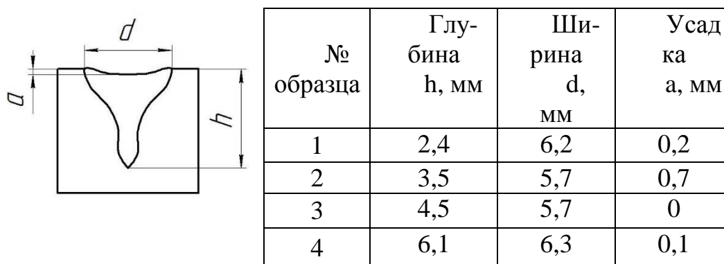
Рисунок 2 – Геометрические параметры сварных швов образцов
