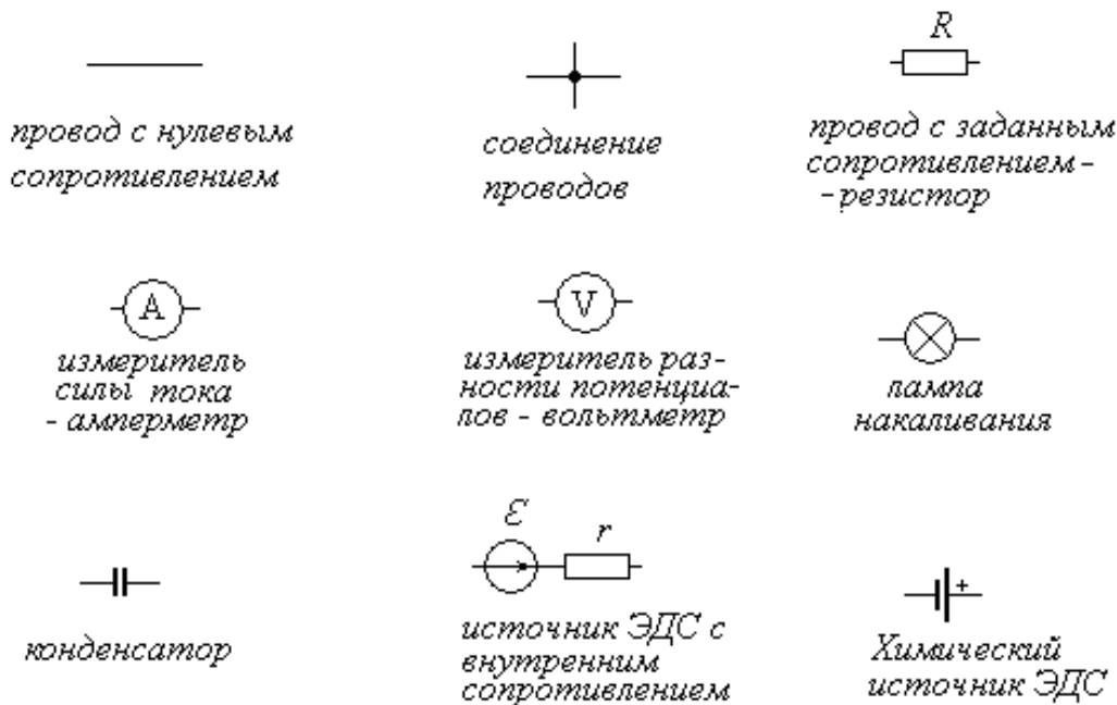
Рис. 2. Условные обозначения некоторых элементов электрических схем
