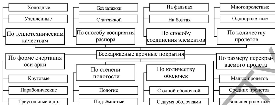
Рис. 5. Классификация основных видов бескаркасных арочных покрытий
