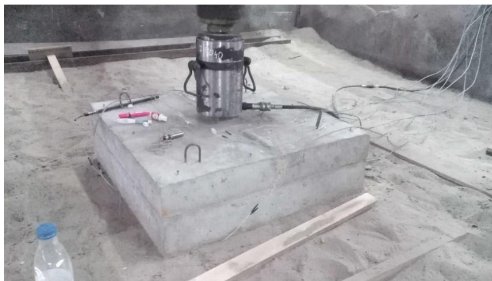
Рисунок 5 – Подготовленный к испытаниям образец
