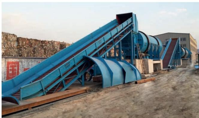
Рис. 2. Пластинчатый конвейер (*Apron conveyor*)
