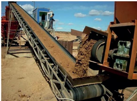
Рис. 1. Ленточный конвейер (*Belt conveyor*)
