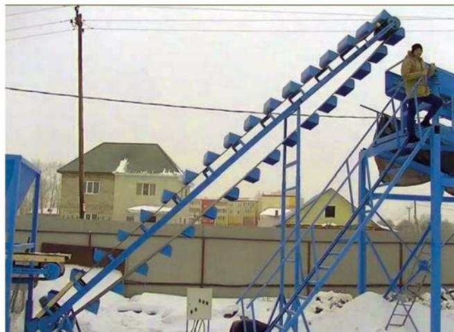
Рис. 6. Ковшовый конвейер (*Bucket conveyer*)
