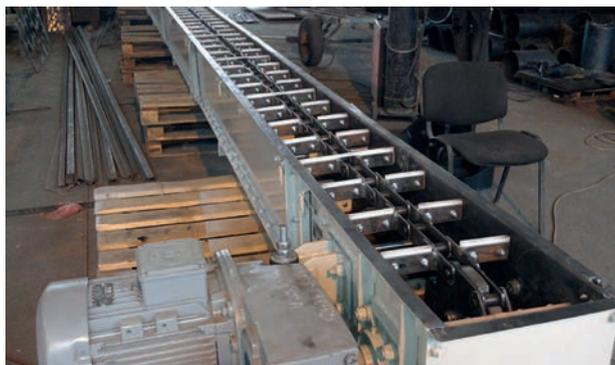
Рис. 3. Скребокый конвейер (*Scrapер conveyor*)
