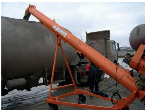
Рис. 4. Винтовой конвейер (*Screw conveyor*)
