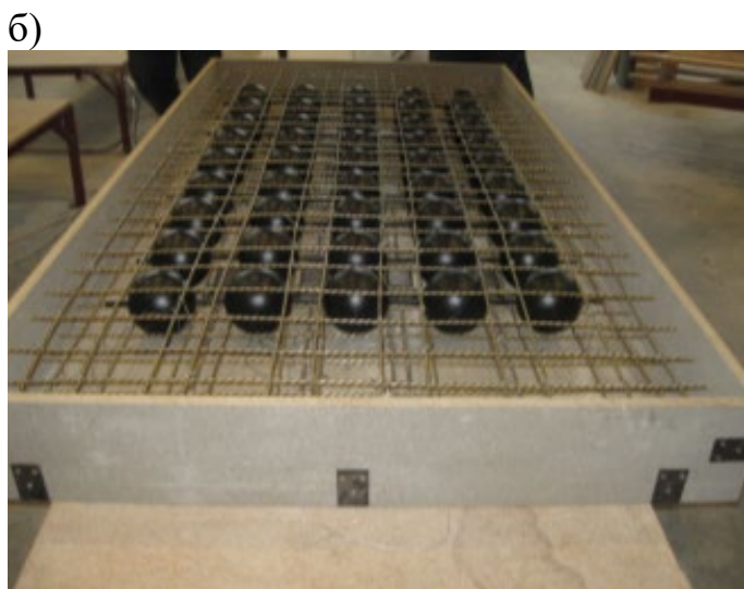
Рисунок 1 – Общий вид экспериментальной многопустотной плиты с несъемной опалубкой из цементно-стружечной плиты
