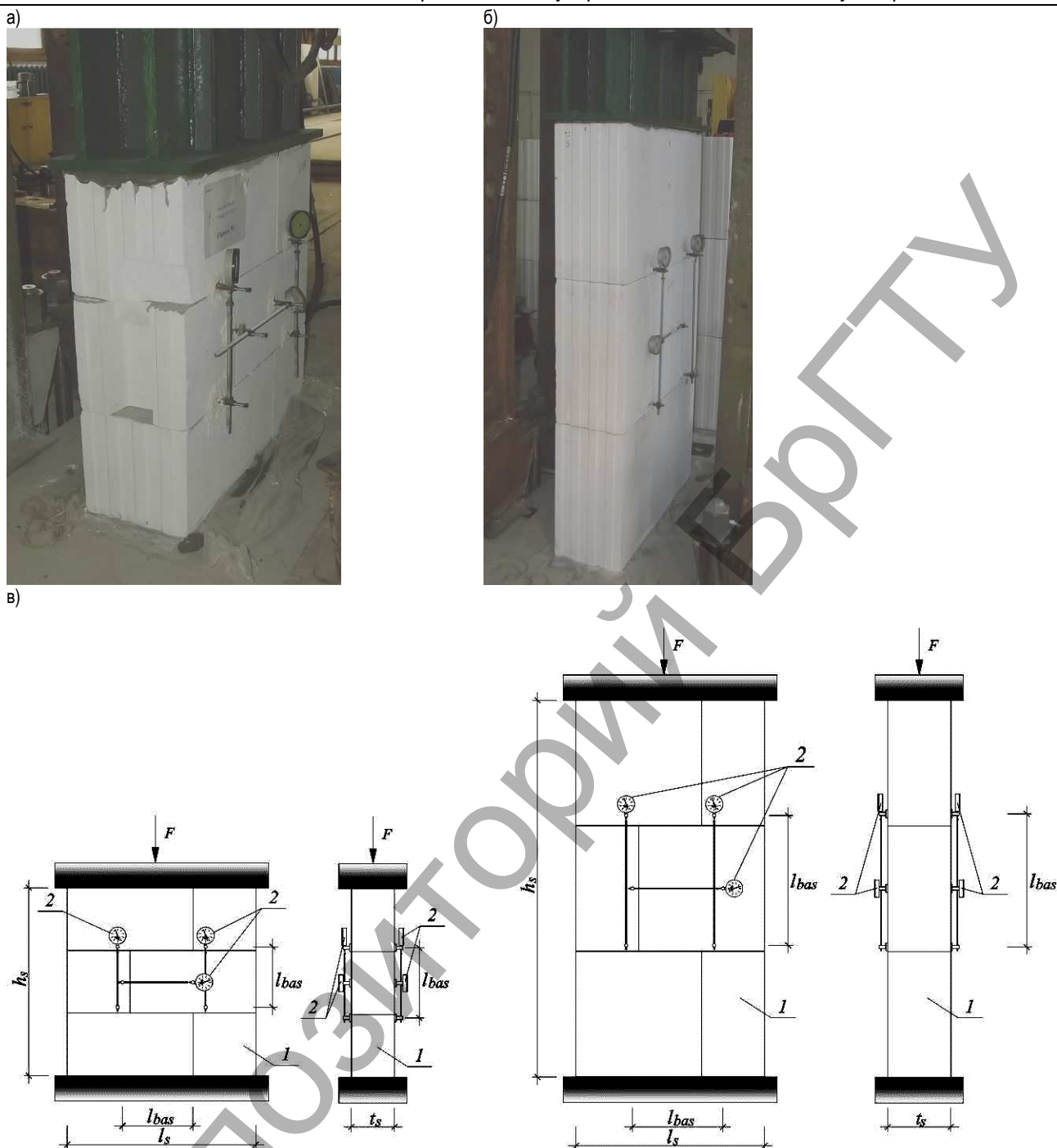
1 – образец кладки, 2 – индикаторы перемещений часового типа ИГП-1 с ценой деления 0,001 мм; h_s = 750 \dots 1500 мм; l_s = 750 мм; t_s = 248 мм а, б – общий вид образцов серий b250, bb250, в – схемы расстановки приборов
