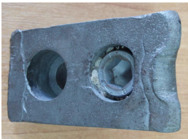
Рисунок 2 – Характер износа ножа
