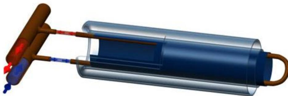
Рис. 2. Устройство прямоточного вакуумированного коллектора
