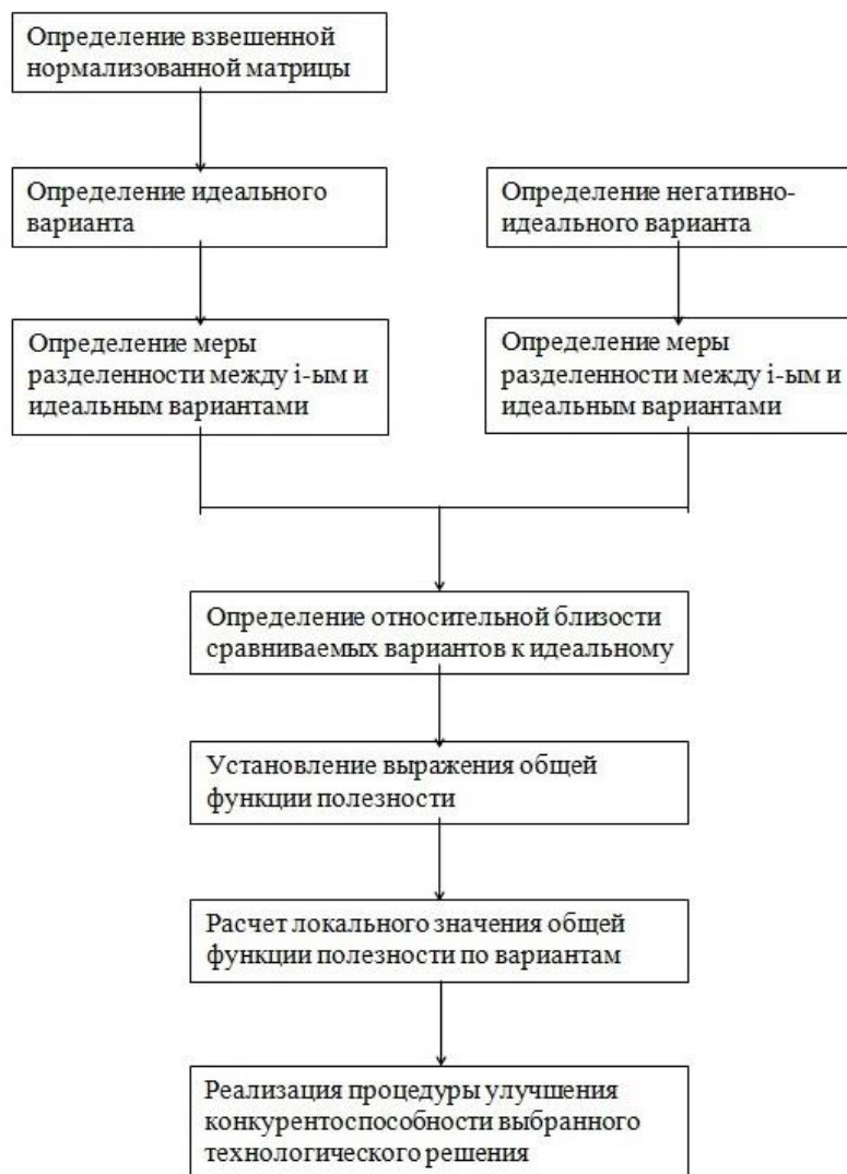
Рисунок 1 - Расчетная блок-схема определения общей функции полезности и улучшения конкурентоспособности выбранного плитно-свайного фундамента
