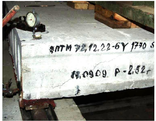
Рис. 8. Разрушение эталонной плиты 2ПТМ72.12.22-9Y1770S7-1 по наклонному сечению при пролете среза c = 2,8d
